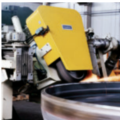
Kantenvorbereitung an Böden
